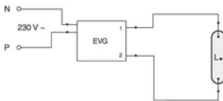
Fonctionnement au BE jusqu'à 400W
