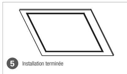
**REMARQUE :** l'espace entre la dalle et le plafond supérieur doit être supérieur à 200 mm
