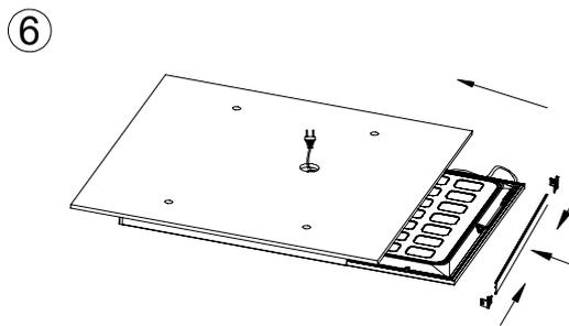
**Placer le panneau dans le sens de la flèche, puis brancher l'alimentation électrique (L-L;N-N) et installer le cadre latéral court.**
