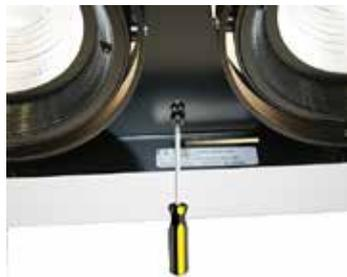
• Visser à l'intérieur la vis cruciforme qui permet d'ouvrir le crochet.
