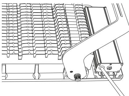
**ES** Instale la luminaria en la posición deseada, atornillándola al accesorio de sujeción en donde vaya a ir colocada por los orificios que se encuentran en la lira.
