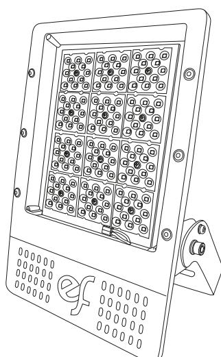
**ES** Fácil acceso a los componentes eléctricos con conectores rápidos que permiten hacer modificaciones o reparaciones de forma sencilla sin necesidad de desmontar la luminaria. Consultar manual de montaje de NTE para saber las herramientas necesarias.
