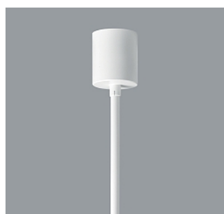
12446.000 Suspension par tube rigide Tube de suspension : métal, revêtement par poudre. Ø 13mm, L 1040mm. Cache-piton : matière synthétique. Ø 64mm, H 73mm. Charge 20kg. Blanc CE Seulement associé à 78671.000 79551.000 79556.000 79561.000 79566.000 79571.000
