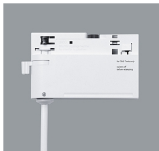
79209.000 Jonction en T DALI Matière synthétique. Conducteur de terre à gauche. Alimen- tation possible. Repiquage. Blanc CE
