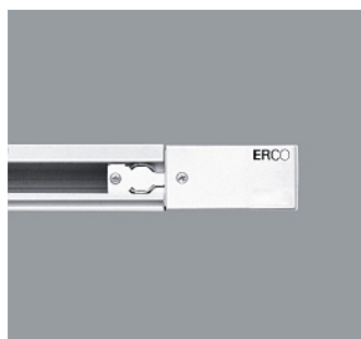
79301.000 Alimentation triphasée Matière synthétique. Conducteur de terre à gauche. Blanc ⚡ ⚠ CE
