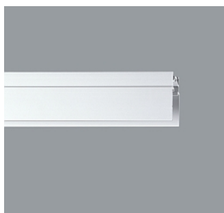
78350.000 Profilé d'encastrement sous crépi Profilé d'aluminium, anodisé argent. Pour un montage des rails lumière au ras des plafonds sous crépi. B 40mm, H 52mm, L 3000mm. Poids 3,00kg
