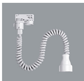
79053.000 Adaptateur triphasé ERCO avec prise de sécurité. 250V, 6A. Câble spiralé 3x0,75mm 2 . L 700/1400mm. Blanc
