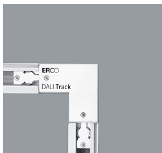
79207.000 Equerre de jonction DALI Matière synthétique. Conducteur de terre extérieur. Alimen- tation possible. Repiquage. Blanc CE
