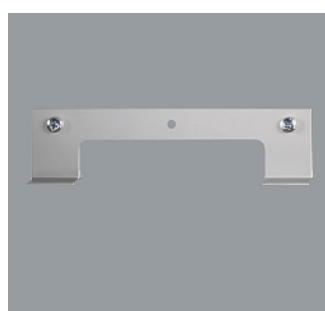
79501.000 Barrette de suspension pour raccords horizontaux de rails lumière. Métal, galvanisé. La barrette de suspension peut être installée ultérieurement par le haut dans le rail lumière ERCO. Charge 20kg. L 180mm, H 47mm.
