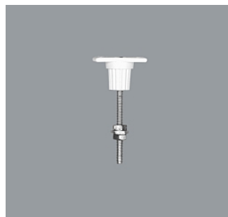
79528.000 Pièce de montage avec tige filetée M4 et deux écrous. Matière synthétique/Acier. Charge 10kg. L 55mm.
