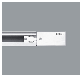
79300.000 Alimentation triphasée Matière synthétique. Conducteur de terre à droite. Blanc ⚡ ⚠ CE
