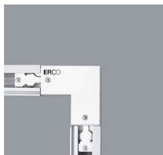
79306.000 Equerre de jonction triphasée Matière synthétique. Conducteur de terre intérieur. Alimenta- tion possible. Repiquage. Blanc ⚡ ⚠ CE
