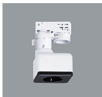
79023.000 Adaptateur triphasé ERCO avec prise à contacts protégés. 250V, 10A. Matière synthétique. Recouvrement : matière synthétique, noir. L 71mm, B 56mm, H 90mm. Blanc CE
