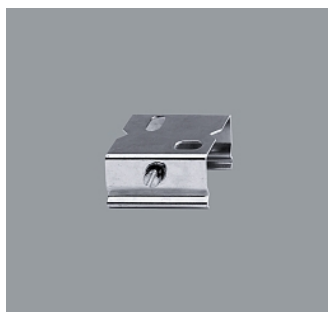
79503.000 Clip de fixation Acier à ressort, galvanisé. Charge 20kg. L 33mm. Ecart du mur 14mm.
