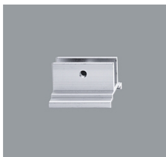
79504.000 Jonction bout à bout avec deux vis. Aluminium, anodisé. Charge 30kg. L 50mm, H 26mm.
