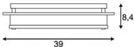
L'applique et plafonnier de qualité élevée GLASSA est composée de verre renforcé par des éléments en acier supplémentaires. Développé pour l'utilisation de sources E27 classiques ou basse consommation, le luminaire GLASSA est prêt pour le raccordement direct à la tension secteur 230V. Ce luminaire peut être utilisé pour des sources de classes énergétiques : E - A+
