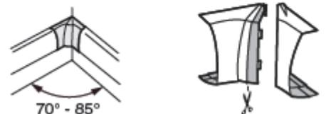
Pour un angle inter allant jusqu'à 140°, utiliser la 3ème pièce élastique (adaptateur) livrée avec.
