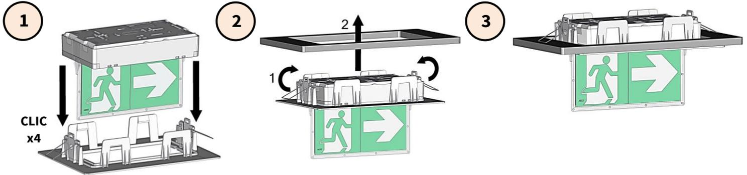
Utiliser le gabarit imprimé au dos du carton d'emballage du kit d'encastrement pour réaliser la découpe.
