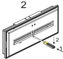
2- Retirer le bloc de la pré-plaque en introduisant un tournevis dans la griffe "P"
