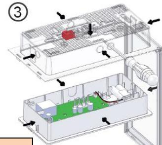
Le bloc est livré batterie déconnectée. Connecter la batterie à la carte pendant l'installation.
