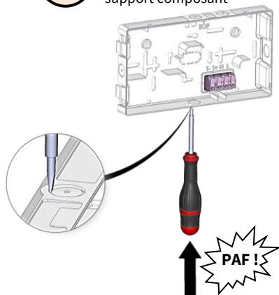
Tournevis recommandé : Tournevis pour vis à fente Ø 0.8 x 4 x 100 mm
